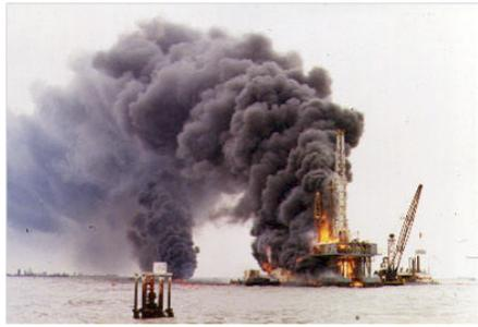
El evento de surgencia puede ocurrir en distintos momentos de tareas en el pozo, durante actividades de perforación donde se está inyectando lodo en el pozo o durante momentos de no perforación donde no se inyecta lodo al pozo y la bomba se encuentra apagada [1].
