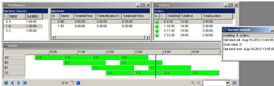
Figura 1: Diagrama de Gantt, con 4 máquinas y 4 pedidos.
