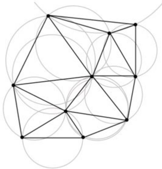
Figura 1: Triangulación de Delaunay de un conjunto de puntos.
