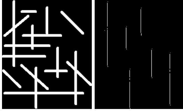
Figura 1.2.: A la izquierda, la imagen original. A la derecha, la imagen resultante de la convolución con el filtro.
